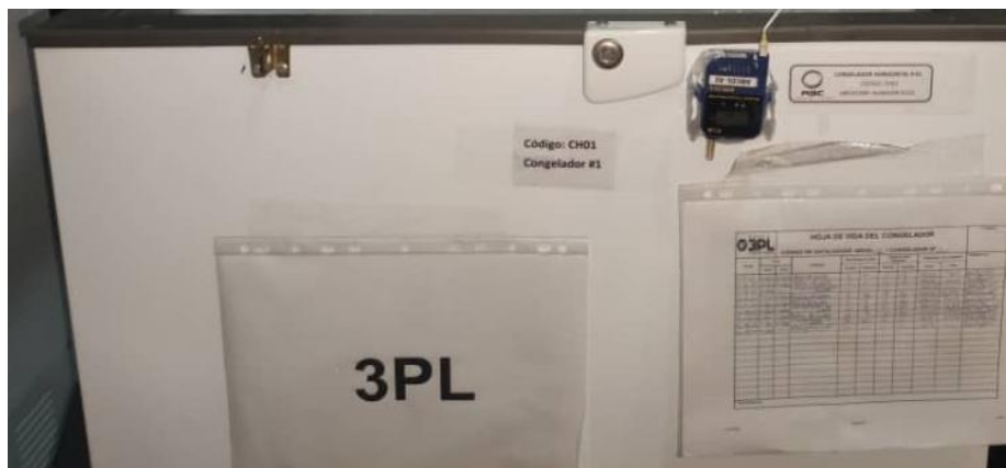
Figura 9. Congelador de geles con registrador electrónico ( datalogger ) y sonda para recolectar temperatura de los geles congelados.
