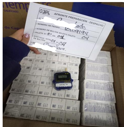
Figura 12. Registrador electrónico ( datalogger ) ingresado en el medio isotérmico pasivo.
