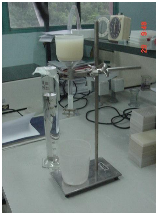
Figura 15. Preparación de la columna de DEAE-celulosa para separación de los parásitos
