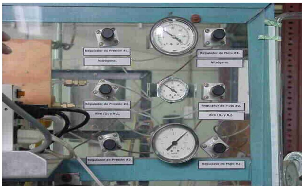
Figura N°4.1.- Válvulas de control de flujo y control de presión para los gases reactivos.
