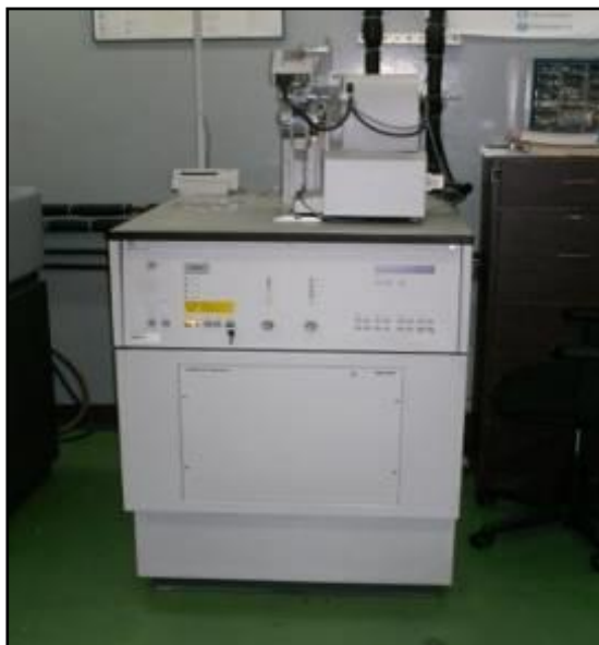
Figura 13. Difractómetro de rayos X marca Phillips, perteneciente al Laboratorio de Rayos X de PDVSA Intevep.
