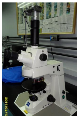
Figura 17. Derecha: Microscopio petrográfico ZEISS, MODELO AXIOSKOP 40, con cámara Canon Power Shot 620 de 7.1 Mega Pixels. Izquierda: tabla comparativa de escala de la imagen según el zoom de la cámara, para cada objetivo del microscopio
