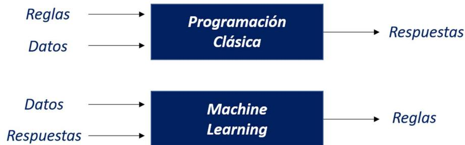
Figura 19: Diferencia entre la programación clásica y machine learning.
