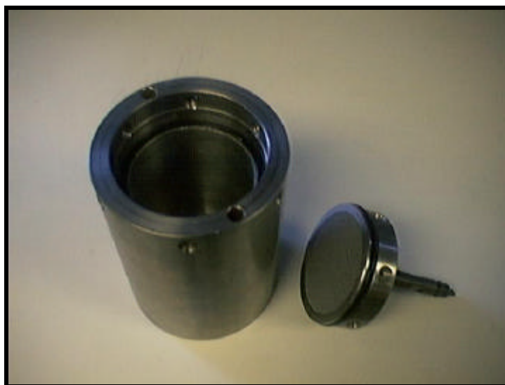
Figura 3.6 Celda contenedora de lodo del equipo AT-AP.
