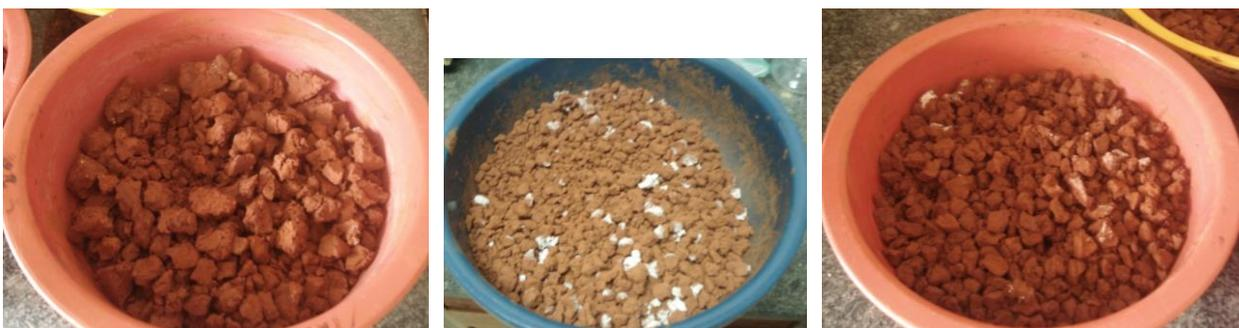
**Figura 6** - Muestras de lodos rojos después de secar en la estufa.
