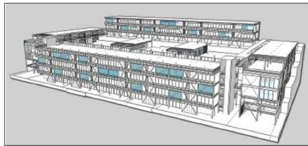
Imagen 08: Modelo de conjunto de edificaciones multifamiliares de desarrollo progresivo con SIEMA-VIV en terrenos en pendiente tipo Escalonada. Fuente: Mendoza, L.
