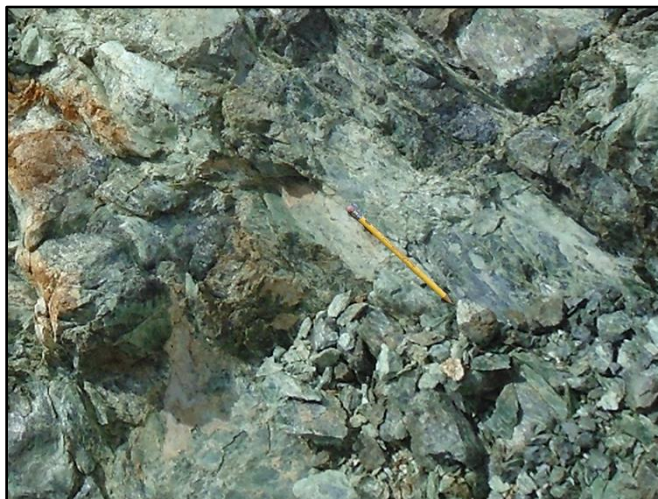
Figura 6.10. Fotografía de Serpentinita, ubicada en nivel 1240 este del sector II. Afloramiento fuertemente diaclasado.
