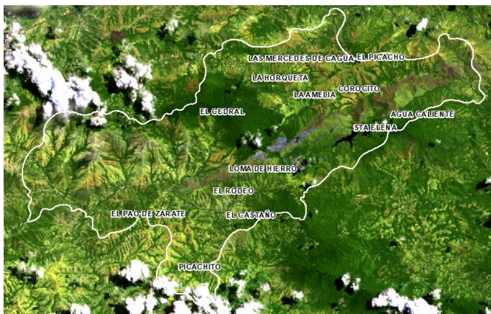
Figura 5.9. Imagen satelital con la combinación de las bandas (7,6,4) donde áreas de vegetación está representada por los tonos verdes mientras que las zonas urbanas, minería, cultivos por los tonos magentas.
