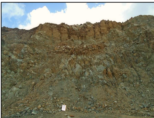
Figura 6.12. Fotografía afloramiento de saprolita dominado por Serpentinitas, ubicado en nivel 1270 noreste del sector II. Este se encuentra con alta concentración de óxidos de hierro, además de presentar diaclasas rellenas por la sílice.
