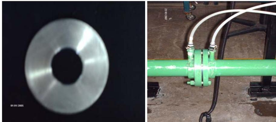
Figura (14): Placa de orificio y su porta placa
