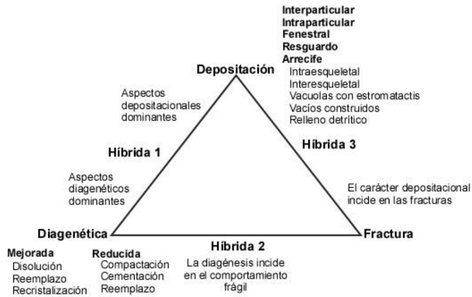
Figura III.9. Esquema de clasificación genética de porosidad en rocas carbonáticas (Tomado y traducido de Ahr, 2008).
