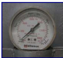
Figura N° 25. Manómetro de 3000 psig.
