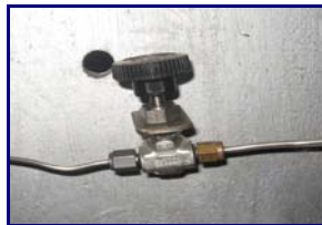
Figura N° 32. Soporte soldado a la plancha de acero para fijar la válvula de aguja.
