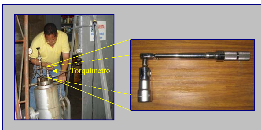
Figura N° 34. Proceso de apertura del autoclave con ayuda de un torquímetro.
