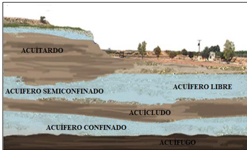
Figura 4.4 Tipos de acuíferos según las presiones hidrostáticas. (Hispaqua, 2020).
