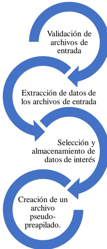
Figura 4.3. Flujo de trabajo del módulo utilidad.py
