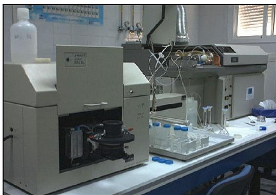
Figura N° 22 Equipo de *Espectrómetro de plasma acoplado inductivo*
