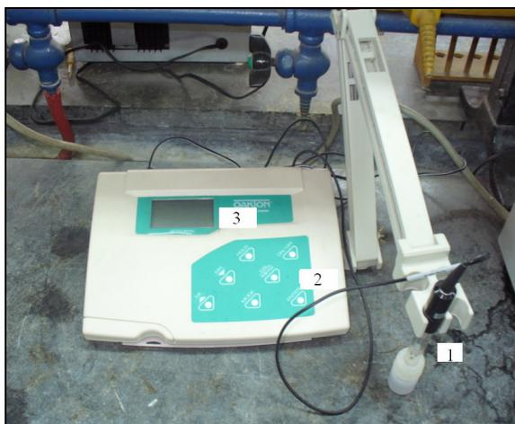
Figura N° 21 *pH-metro*. 1 Electrodo pH, 2 Botones reguladores, 3 Pantalla digital
