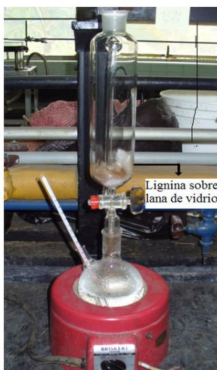
Figura N°16 Montaje para el tratamiento térmico con vapor de agua
