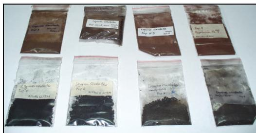
Figura N° 26 Diferencia de color en las ligninas; (arriba) muestras obtenidas a baja concentración, (debajo) muestras obtenidas a alto concentración.
