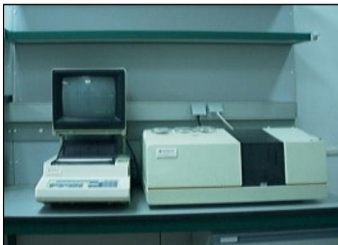
Figura N° 23 Equipo de Espectrofotómetro de infrarrojo.
