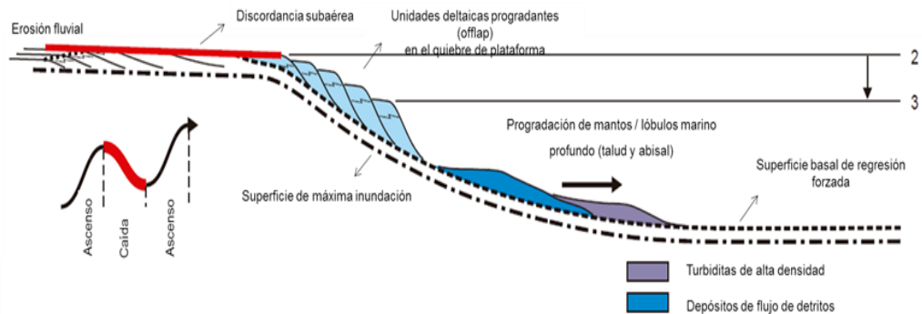
Figura-15: Sistema de decaimiento del nivel base: Tasa baja de progradación, cae el nivel de base generando una regresión forzada (tomado y modificado de Catuneanu et al. , 2006).
