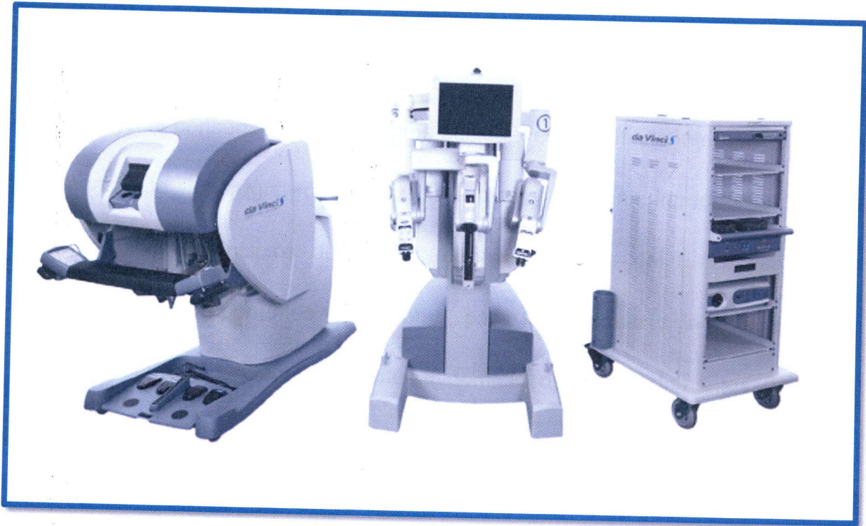
Figura N°1. Sistema Da Vinci® S HD (Intuitive Surgical Inc®) Programa de Cirugía Robótica – Hospital Universitario de Caracas.
