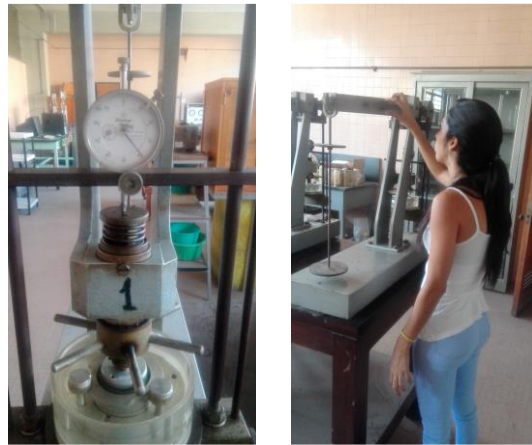
Figura 2.3. Equipo edométrico utilizado en ensayo de expansión
