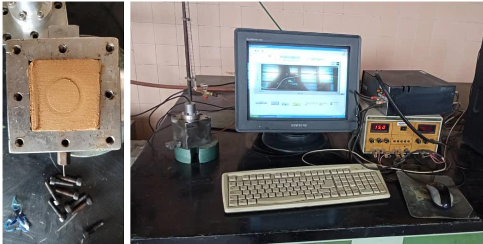
Figura 2.8. Muestra ajustada a celda de medición 3D BOX
