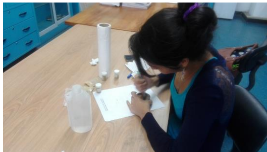
Figura 2.10. Pulverizado de muestra para ensayo de difracción de rayos X
