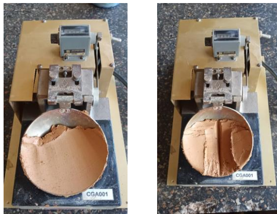
Figura 2.1 Preparación de muestra para Ensayo de Casagrande Límite Líquido
