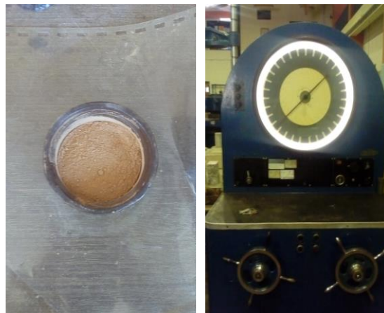
Figura 2.4. Preparación de la muestra y equipo utilizado para compactación mecánica
