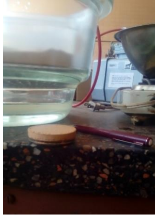
Figura 2.5. Muestra para ensayo edométrico
