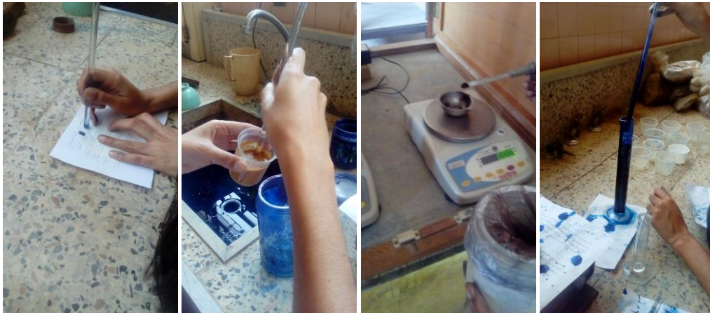
Figura 2.2. Pasos realizados en el ensayo de Azul de Metileno
