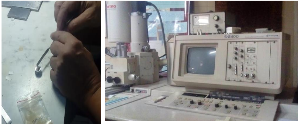
Figura 2.9. Preparación de la muestra y equipo utilizado en microscopia electrónica de barrido
