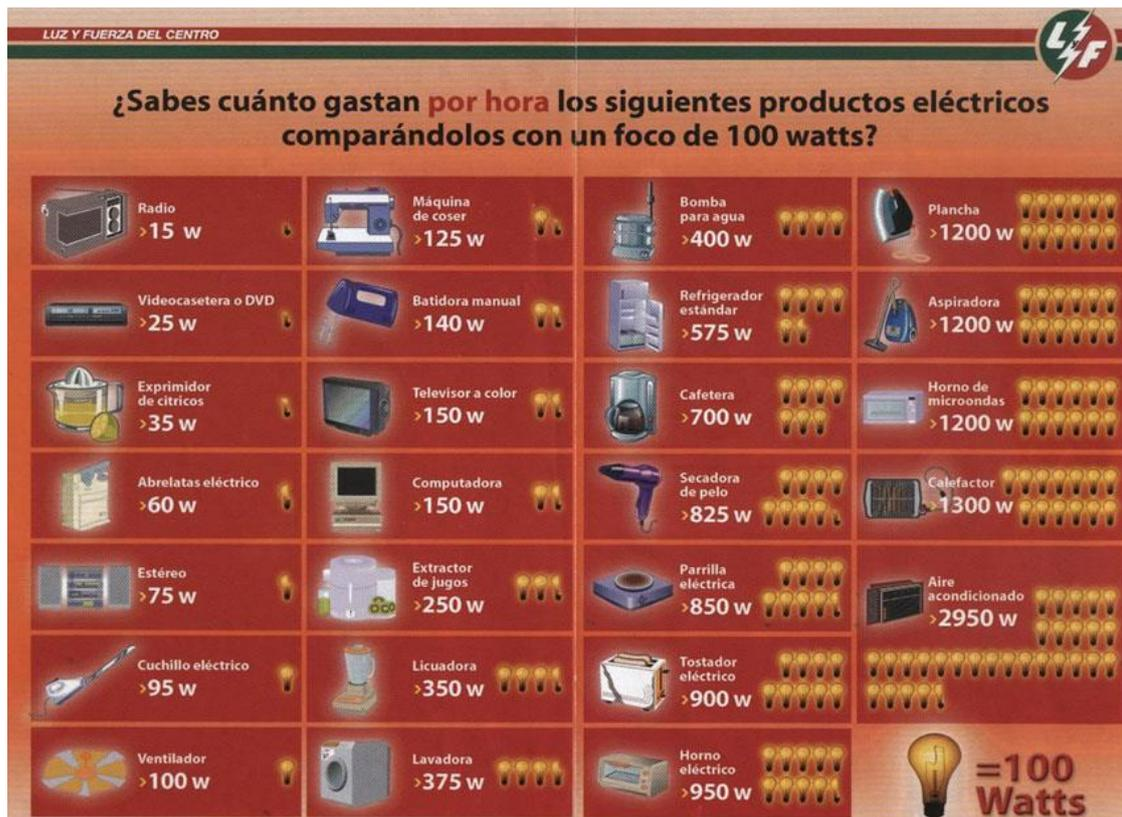
**Figura 42.** Consumos eléctricos, por hora, de algunos electrodomésticos comparados con un foco (bombillo) de 100watt.
