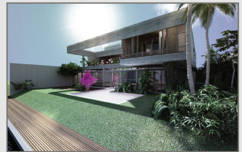
(11) Perspectiva del anteproyecto que muestra, a partir del cálculo preciso de su recorrido, la incidencia solar sobre el área de piscina. (solsticio de verano, 4:30 pm)
