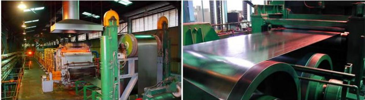
Ilustración 20. Proceso de laminación y galvanizado. Fuente: Lamigal
