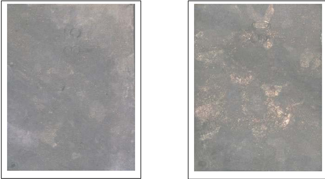
Figura 1: Comparación visual de las probetas con 3 minutos de inmersión correspondientes a las estaciones INC (35) y Planetario (30) después de 6 meses de exposición.
