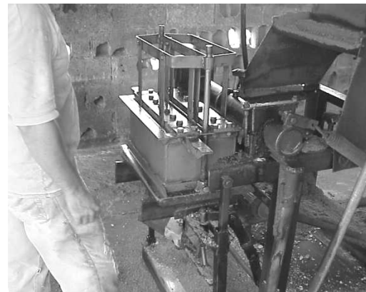
Fotos 1: Llenado de la mezcladora con los agregados y máquina vibrocompactadora. Archivo personal
