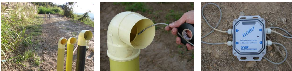
Figura 1.6.- Proceso de colocación de sensores.
