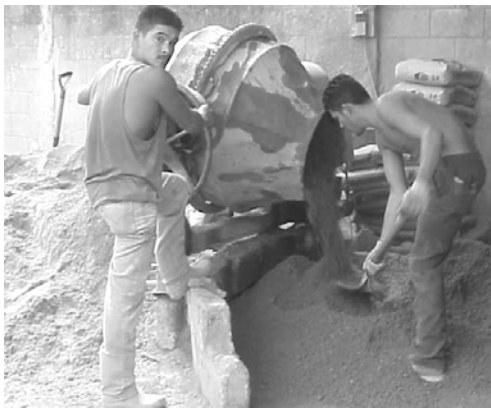
Fotos 1: Llenado de la mezcladora con los agregados y máquina vibrocompactadora. Archivo personal
