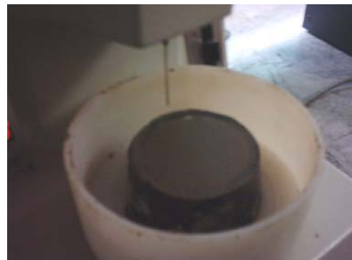
FIGURA N° 9. Ensayo de Fraguado.
