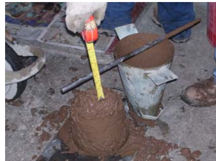
FIGURA N° 11. Medición del Asentamiento.
