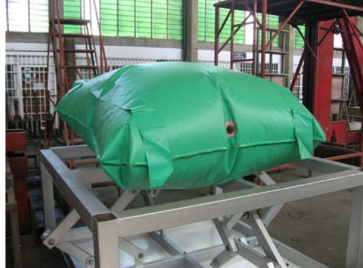
Figura 8 Mecanismo para mantener la horizontalidad del marco
