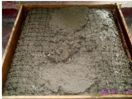
Figura 8: Panel de mortero reforzado con mallas de plástico (Fuente: Fotografía tomada por Solangel Mejía)
