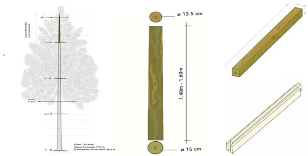
Fig4: Sección final o fuste del árbol de pino caribe aprovechable para el desarrollo del componente de madera.
