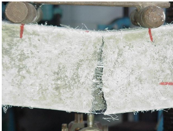
Figura 5: Probeta de mortero reforzado con fibras de Sisal ensayado a la flexión (Fuente: Fotografía tomada por Yuraima Centeno)
