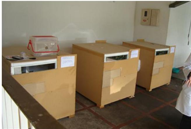
**Figura 2:** Ubicación de los 3 módulos del prototipo experimental (de izquierda a derecha): Módulo control (MC), Módulo no ventilado (MNV), Módulo ventilado (MV). Fuente: elaboración propia.
