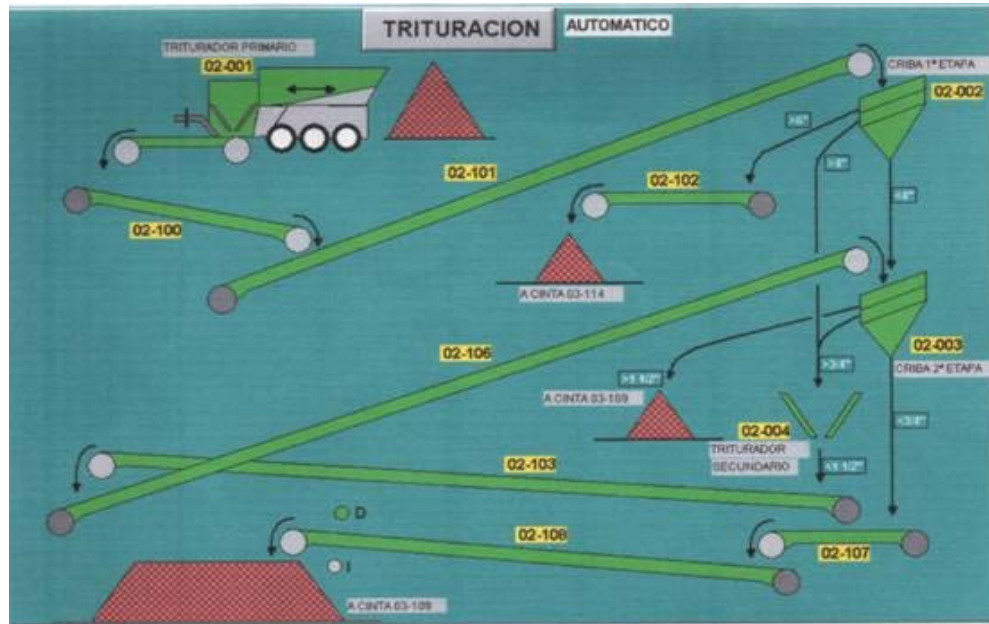
Fig.2.1 Diagrama en pantalla del Área de Trituración, presentado por el software SCADA empleado por la planta Piloto.
