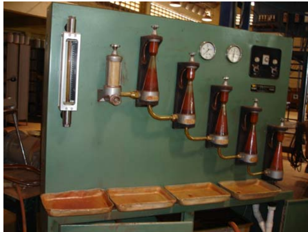
Fig. 3.6 Ciclosizer, equipo utilizado para la clasificación de finos.
