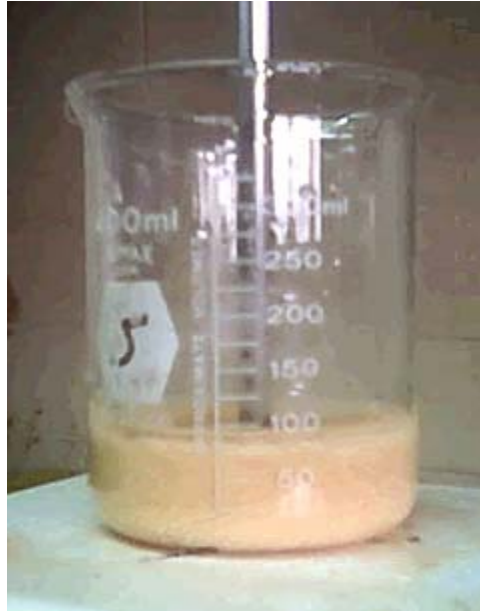
Figura 3.6. Acondicionamiento de la resina con hidróxido de sodio
