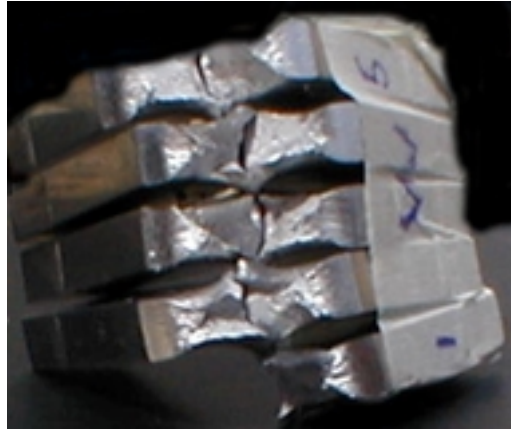
Fig. N° 45. Superficie de fractura de las probetas enfriadas en agua ensayadas por impacto
