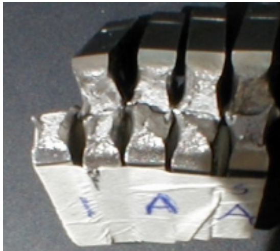
Fig. N° 46. Superficie de fractura de las probetas enfriadas en aire agitado, ensayados por impacto
