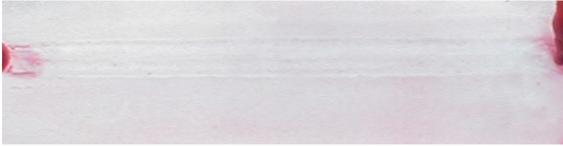
Fig. N° 41. Aspecto de la superficie del cupón de prueba enfriado en agua, evaluado por líquido penetrante.
