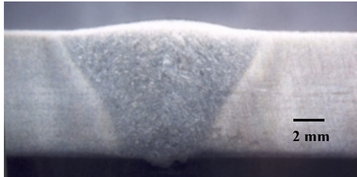
Fig. 14. Vista frontal del cupón de prueba, con penetración total y poco refuerzo de raíz
