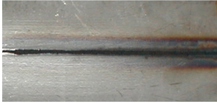
Fig. N° 38. Vista inferior del cordón de soldadura de la muestra enfriada en agua
