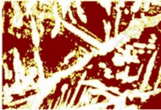
Fig. N° 34. Imagen analizada de la microestructura de la ZF, para la muestra enfriada en aire agitado por medio del programa Digital Micrograph 3.44. La fase coloreada corresponde a la fracción total de Ferrita.
