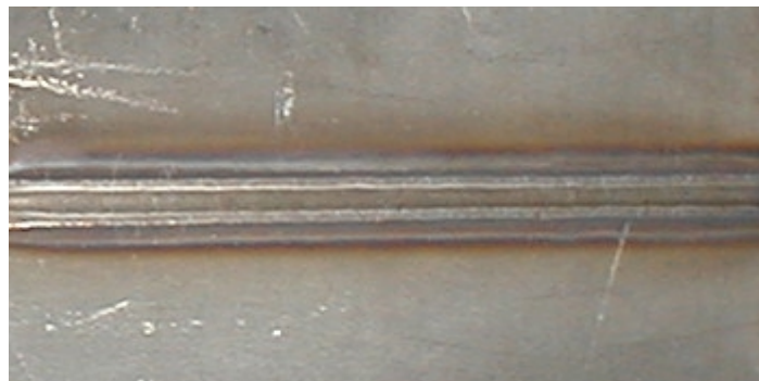
Fig. N° 37. Vista superior del cordón de soldadura de la muestra enfriada en agua
