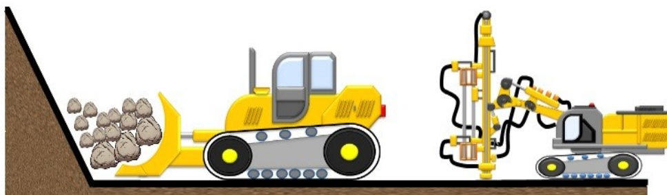
Figura 2: Limpieza del frente de perforación con tractor de orugas.
