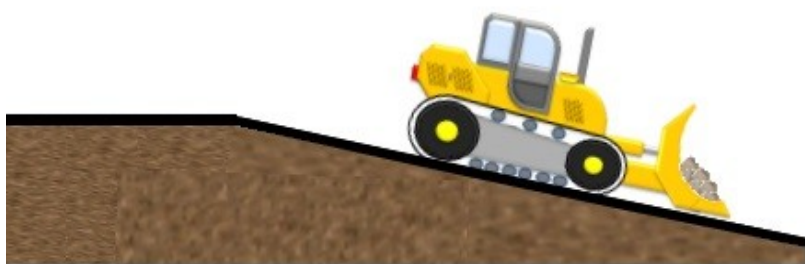
Figura 18: Trabajo con tractor en cambio de pendientes de taludes para recuperación y cierre.
