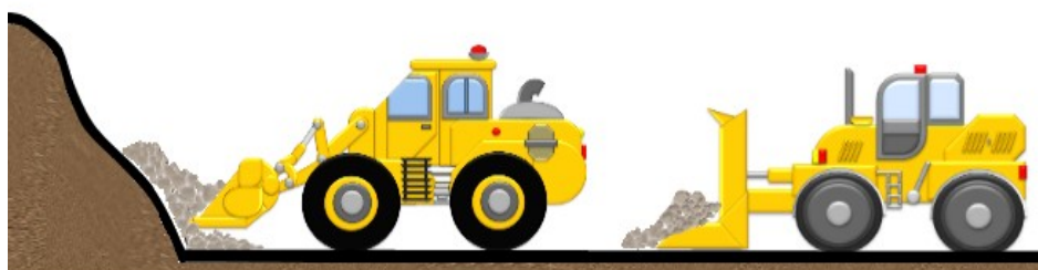
Figura 9: Limpieza del frente para el cargador frontal con tractor de ruedas.
