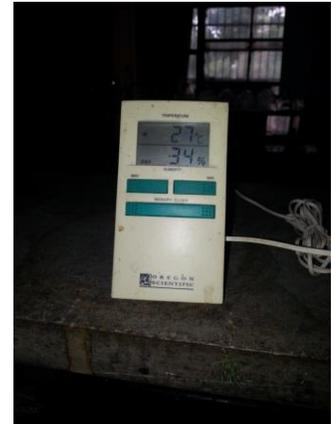
**Figura 107. Hidrotermómetro**
