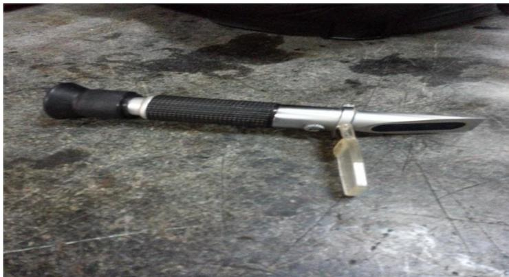
**Figura 72. Refractómetro Manual**
