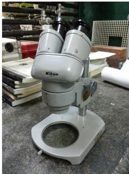
**Figura 114. Lupa estereoscópica**
