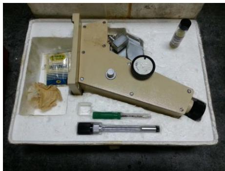
**Figura 73. Refractómetro ABBE**
