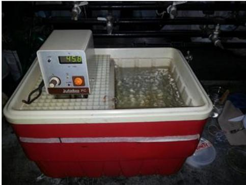
**Figura 105. Cava térmica termostatada (con su resistencia)**
