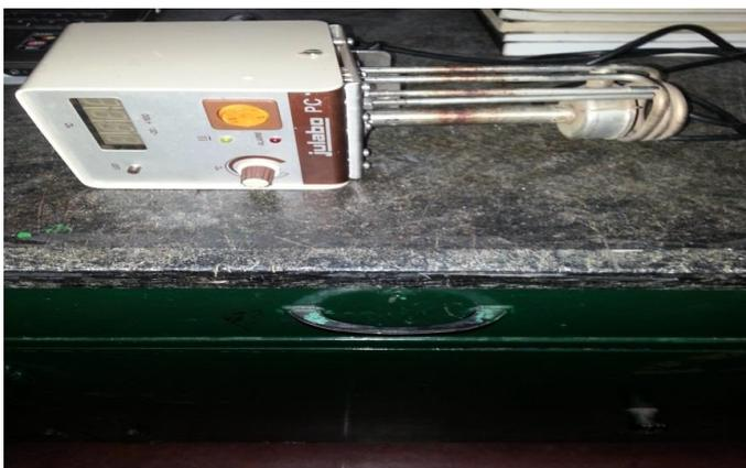
**Figura 108. Equipo con control térmico automatizado Julabo PC**
