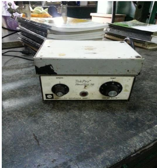
**Figura 116. Agitador calentador**
