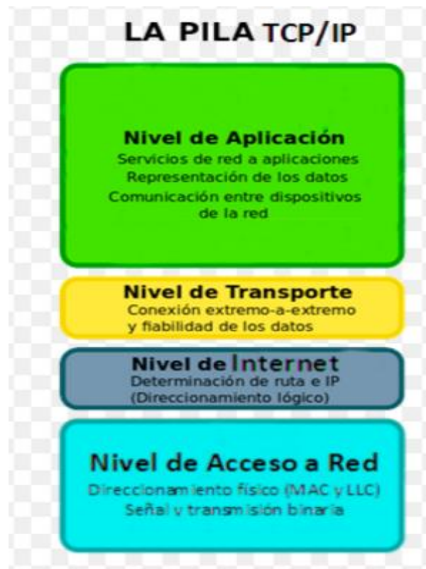
Figura 2.6: Capas de red de la norma TCP/IP.
