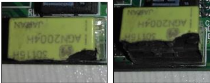
Figura 4.21. Daños del relé de salida
