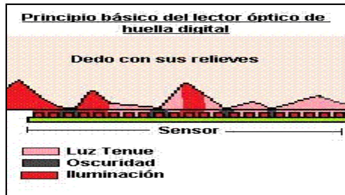
Figura 2.2: Principio básico del lector óptico de huella digital.
