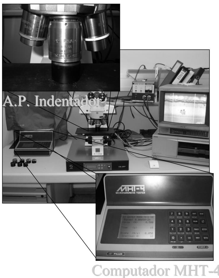
**Figura 3.6** Componentes del equipo utilizado para medir microdureza.
