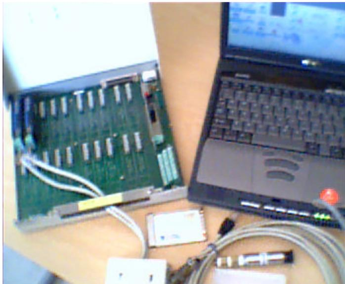
FIGURA 27. Sistema de Adquisición de Datos de Presión
