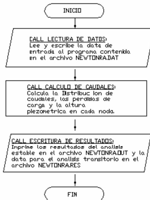
Figura 3. Diagrama de Flujo del Programa Principal para Régimen Estable
