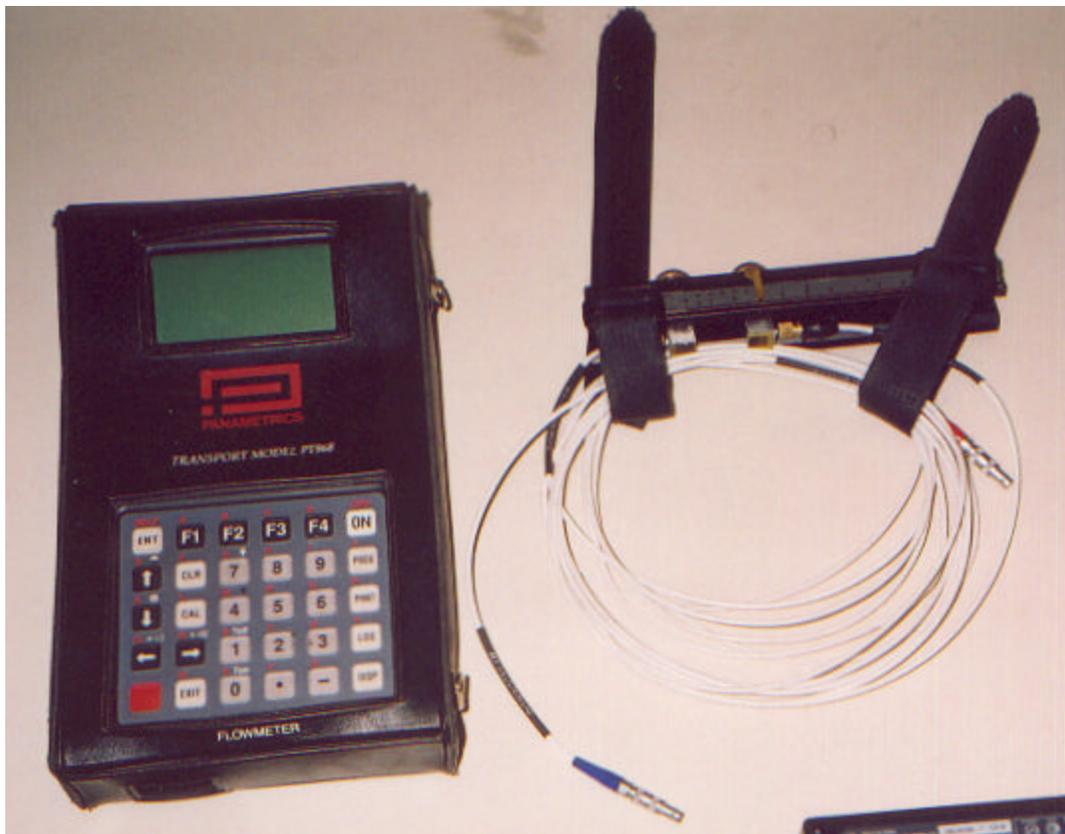
FIGURA 28. Medidor Ultrasónico de Caudal
