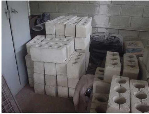
**Figura 15 Depósito de Bloques de Suelo-Cemento**
