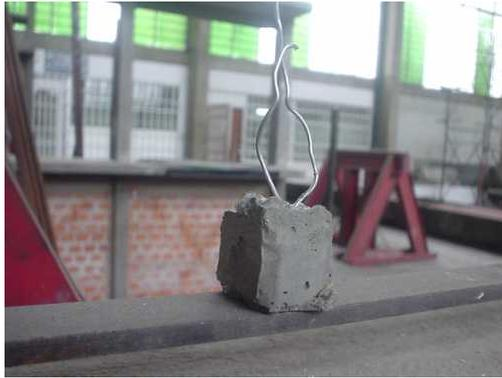
**Figura 21 Separador Aislado**
