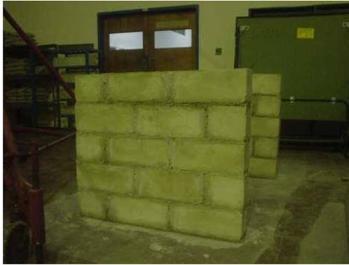
**Figura 29 Murete para Ensayo de Corte**
