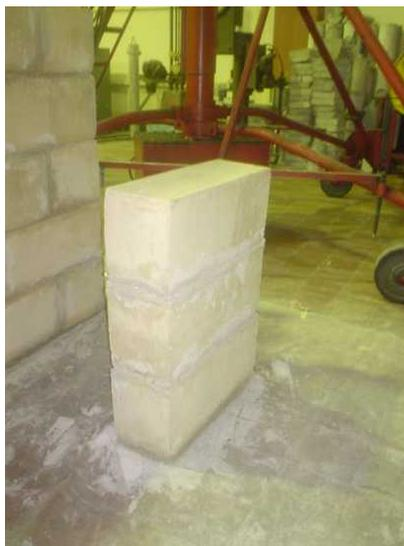
**Figura 28 Pila de Bloques**
