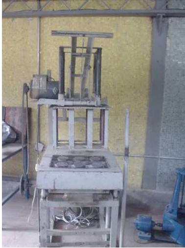
**Figura 11 Máquina artesanal para fabricación de bloques**
