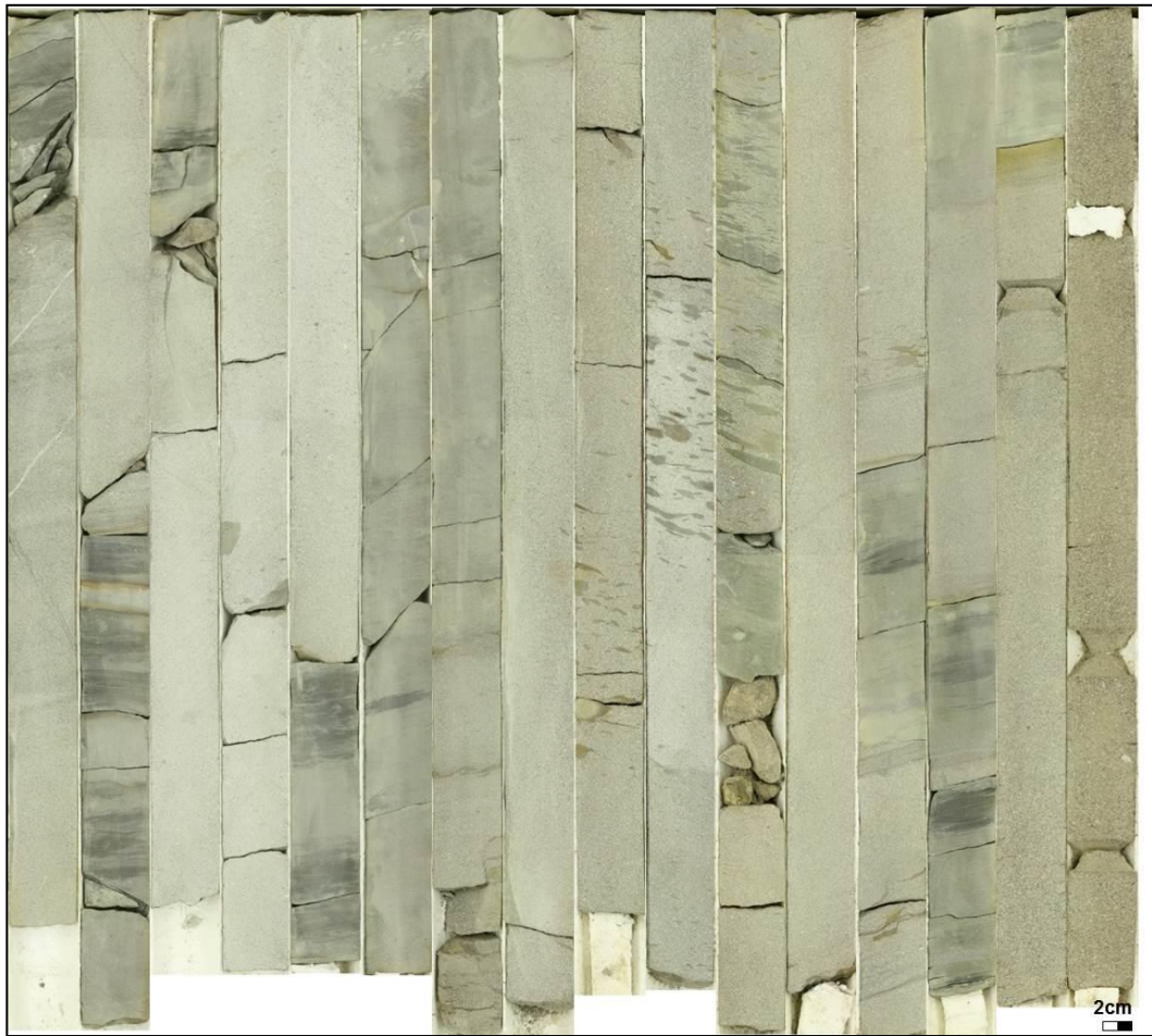
Figura N° 15. Canales de marea, pozo Y-1, profundidad 5827'9''-5845'8''.
