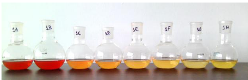
Figura 54. Distribucion de pesos moleculares de compuestos con V extraidos con ACN en maltenos Carabobo.
