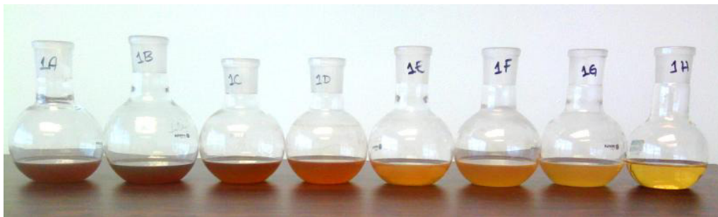
Figura 55. Distribucion de pesos moleculares de compuestos con V extraídos con DMF despues de las extracciones con ACN en maltenos Carabobo.
