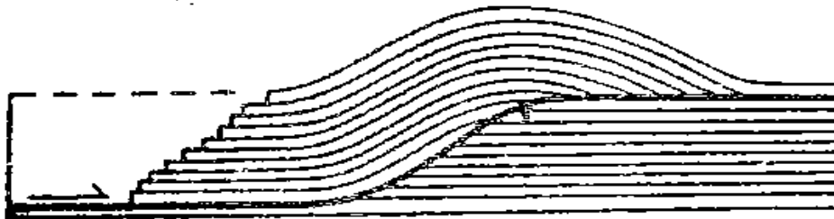
Figura 26. Modelo de Pliegues Concéntricos propuesto por Elliot's. Tomado de “The construction of balanced cross-sections”, 1976.
