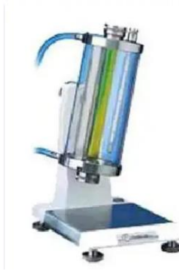
Figura 5. Viscosímetro de caída libre (extraído de https://www.Scribd.com ).
