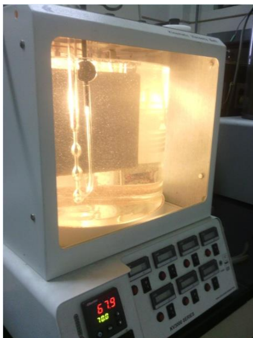
Figura 19. Viscosímetro capilar con la muestra de crudo a analizar, sumergido en un baño de viscosidad cinemática Koehler KV 300 series que opera entre 20-150 °C, en proceso de ambientación previo a la medición de la viscosidad. Equipo del Laboratorio de Instrumental Analítico de la Escuela de Ingeniería del Petróleo de la Facultad de Ingeniería de la UCV.
