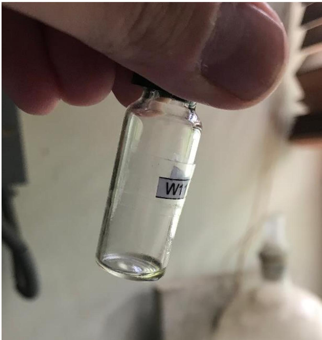
Figura 22. Hidrocarburos aromáticos en la muestra W11 del sector Cotiza.
