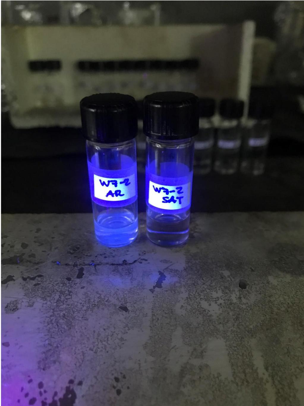
Figura 21. Hidrocarburos aromáticos a través de luz UV (Sector Los Venados).
