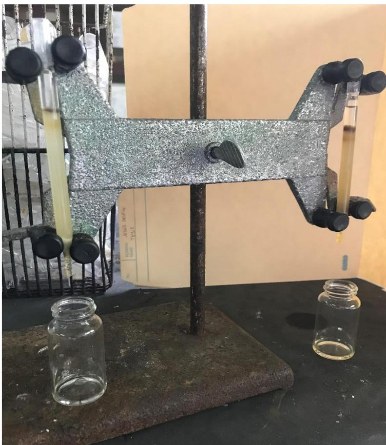
Figura 10. Empacado micro-columna en pipeta Pasteur.
