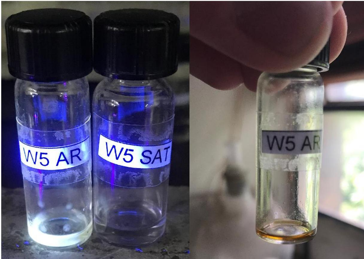
Figura 12. Viales con residuos de hidrocarburos aromáticos (Sector Cachimbo).
