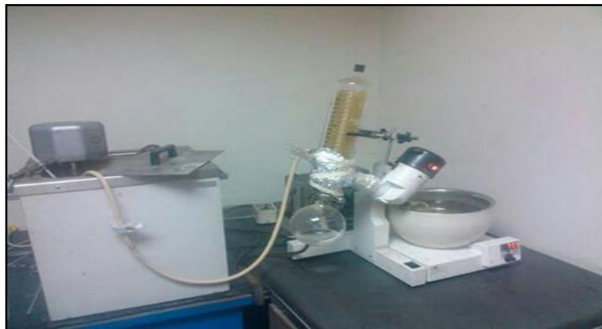
Figura 23. Sistema de rota-evaporación al cual fueron sometidas las muestras.
