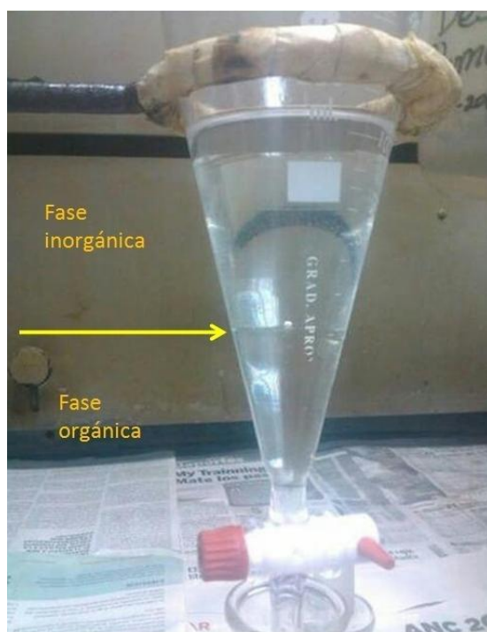
Figura 21. Embudo de separación en donde puede observarse la separación entre la fase orgánica e inorgánica de la muestra con cloroformo.
