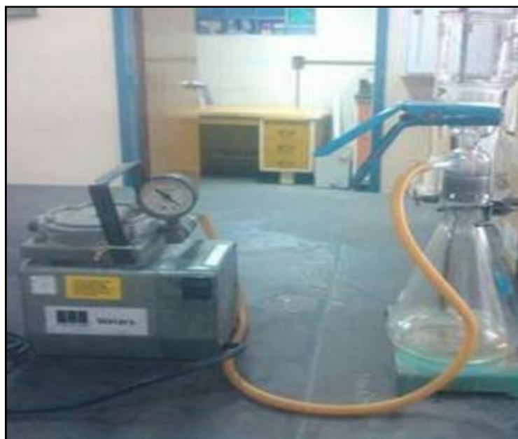
Figura 20. Sistema de filtrado mediante bomba de succión utilizado en las muestras de agua superficial.
