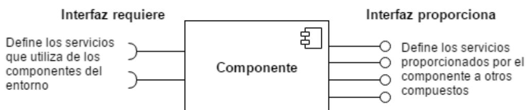
Figura 10 Interfaces de componentes (Sommerville, Ingeniería del Software, 2005)
