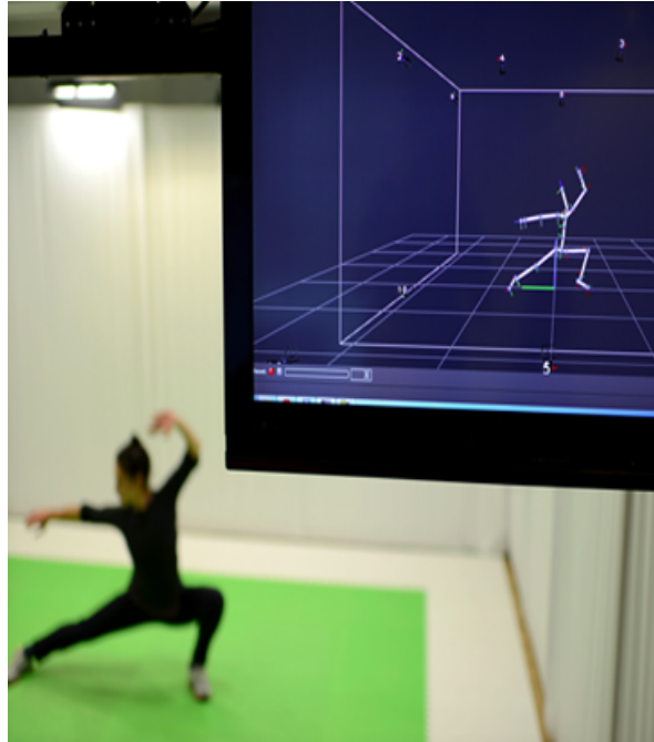
Figura 1.15: Tecnología de visión artificial para identificar y rastrear sujetos sin la necesidad de trajes o marcadores especiales ©Organic Motion, Inc.
