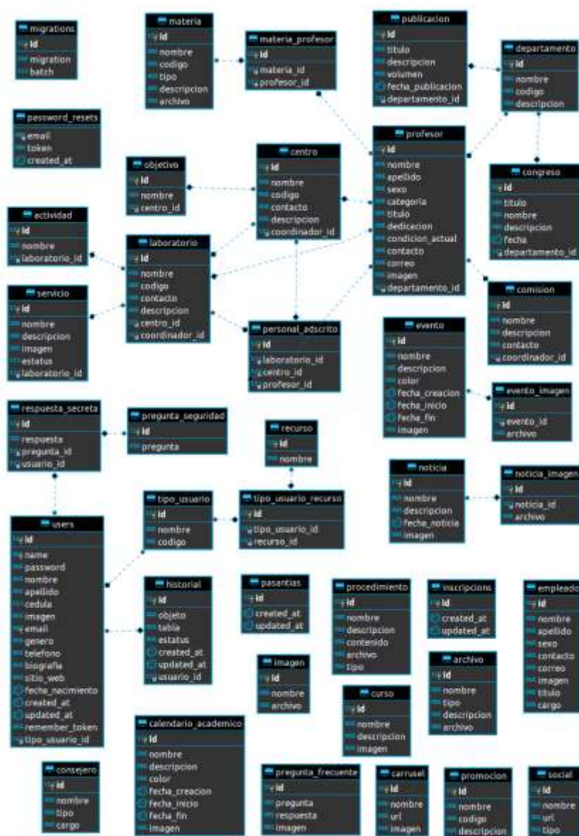
Figura 41 - Modelo Relacional de la Base de Datos del Portal Fuente: Creada por los autores
