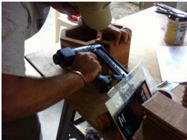
A cada una de las piezas que conforman el molde externo, una vez verificadas, se le colocó cinta adhesiva y cola de madera, se presentaron las piezas y se aseguraron con la clavadora neumática.
