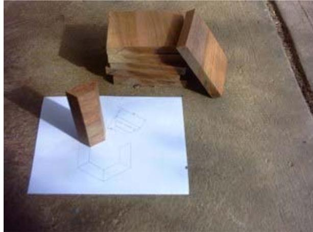
El segundo corte que se hizo a cada pieza del molde interno es con el fin de obtener las superficies de unión, cada pieza fue cotejada frente a los planos de detalle a escala natural para así poder ir evaluando la precisión del trabajo.
