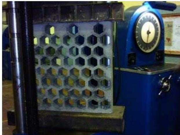
Este ensayo se realizó en el IMME (instituto de Materiales y Modelos Estructurales) para lo cual se colocó el muro prototipo con la ayuda de una grúa dentro de la máquina de ensayos. Para la realización del ensayo de compresión de mureta se colocó en la máquina la viga de acero reforzada (plato de carga) acoplada a la rótula esférica, el eje del centro de la mureta se hizo coincidir con el centro de la viga o plato de carga.
