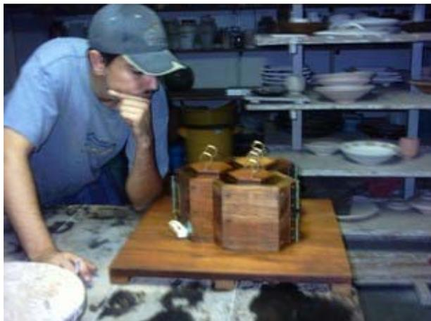
Finalizado el acabado de los moldes de madera, se engrasó las paredes internas del molde externo y las paredes externas del molde interno, quedando así listo para su utilización o fabricación de bloques hexagonales de ventilación.
