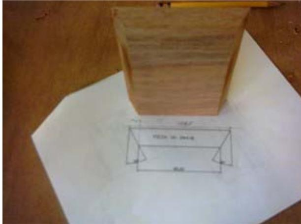
El segundo corte que se hizo a cada una de las piezas del molde externo es con el fin de obtener las superficies de unión, cada pieza fue cotejada frente a los planos de detalle a escala natural para así poder ir evaluando la precisión del trabajo.
