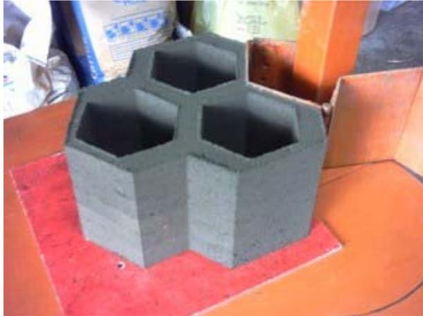
Se utilizó el acrílico laminado para hacer las planchas intercambiables por ser un material del cual ya se disponía, a pesar de que lo ideal, hubiese sido hacer una serie de planchas de hierro de 3mm para el intercambio sistemático entre bloque y bloque. Esto último no se realizó por limitaciones de carácter económico.
