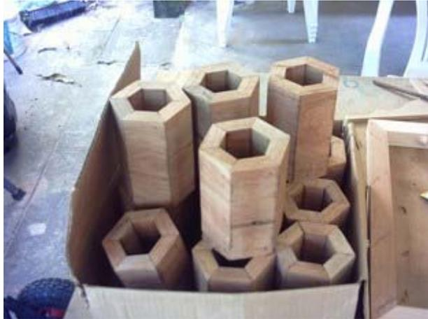
Posteriormente al aseguramiento de cada pieza, se retiró la cinta adhesiva y se le pasó una lija de grano fino para obtener la textura final con lo que concluye la elaboración de los prismas rectos de base hexagonal) o *“molde interno”*.
