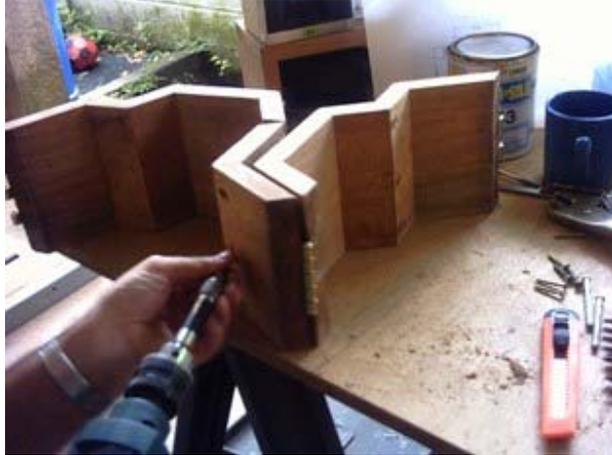
Posterior al endurecimiento de la cola de madera, se fijó las bisagras que sirven como articulación y cierre del molde externo, se coló los tornillos de refuerzo.
