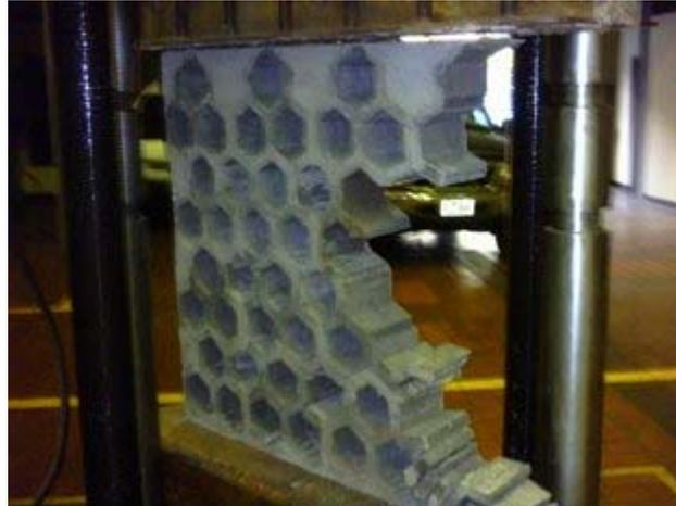
Una vez verificada la correcta colocación de la mureta se dio inicio al ensayo, en el cual se aplicó la carga de forma gradual a una velocidad constante, en este ensayo se obtuvo como carga última 2.900 Kg.
