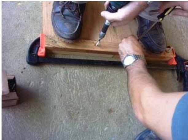
La base de los moldes se realizó con dos tablas de 50cm x 25cm unidas con unos tarugos en los costados, se mantuvieron unidas las tablas con unos sargentos hasta el endurecimiento de la cola, simultáneamente se fijaron unos listones en forma transversal para asegurar una mayor unión de las tablas bases. Posteriormente se fijaron en la parte superior de la tabla unas guías o topes tanto para el molde interno como para el molde externo.
