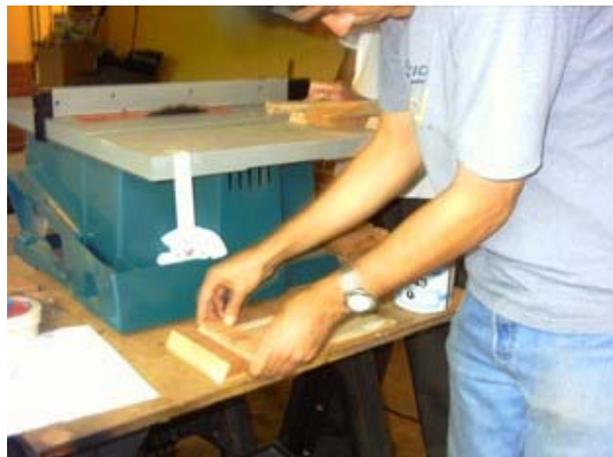
Una vez cortadas todas las piezas que constituyen los prismas rectos de base hexagonal del molde interno, se colocó cinta adhesiva en una superficie que sirvió como guía para aplicar la cola de madera, con el fin de unir las piezas y finalmente asegurarlas con la clavadora neumática.
