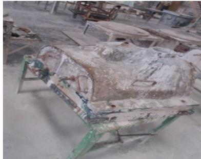
**Figura 7.** Matriz para la fabricación de moldes para el proceso de mezclado en la Compañía Venezolana de Cerámica Vencerámica C.A.
