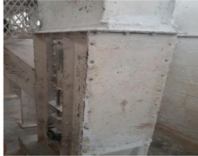
**Figura 3.** Elevador de cangilones para el proceso de mezclado en el área de fabricación de moldes en la Compañía Venezolana de Cerámica Vencerámica C.A.
