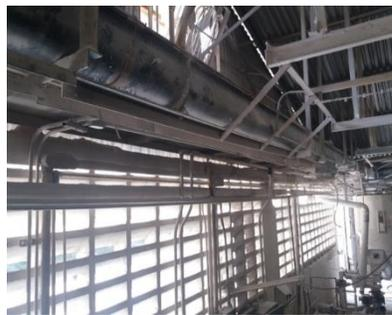
**Figura 4.** Transportador horizontal de tornillo sin fin para el yeso para el proceso de mezclado en el área de fabricación de moldes en la Compañía Venezolana de Cerámica Vencerámica C.A.
