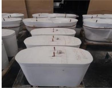
**Figura 14.** Moldes productos del mezclado de yeso y agua en el área de fabricación en la Compañía Venezolana de Cerámica Vencerámica C.A.
