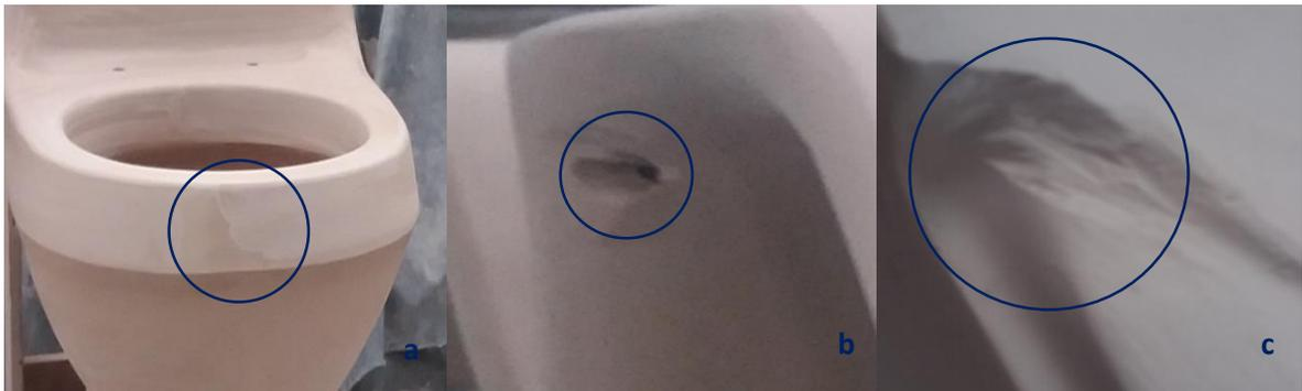
**Figura 18.** Disconformidades en piezas sanitarias en crudo: a) Rajadura. b) Hundido. c) Roto, en la Compañía Venezolana de Cerámica Vencerámica C.A.
