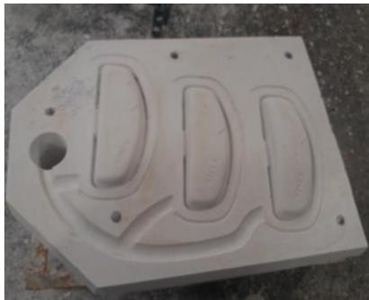
**Figura 11.** Tapa de cierre de un molde de poceta para el proceso de mezclado en el área de fabricación de moldes en la Compañía Venezolana de Cerámica Vencerámica C.A.
