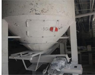
**Figura 5.** Silo para almacenamiento del yeso para el proceso de mezclado en el área de fabricación de moldes en la Compañía Venezolana de Cerámica Vencerámica C.A.
