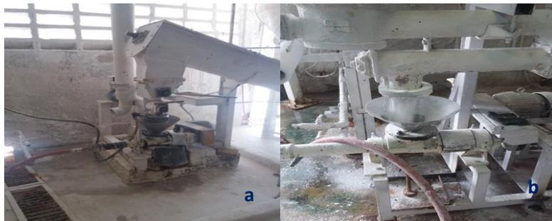
**Figura 6.** Expulsión simultánea del yeso y el agua: a) Tornillo inclinado sin fin. b) Tolva de alimentación, para el proceso de mezclado en el área de fabricación de moldes en la Compañía Venezolana de Cerámica Vencerámica C.A.
