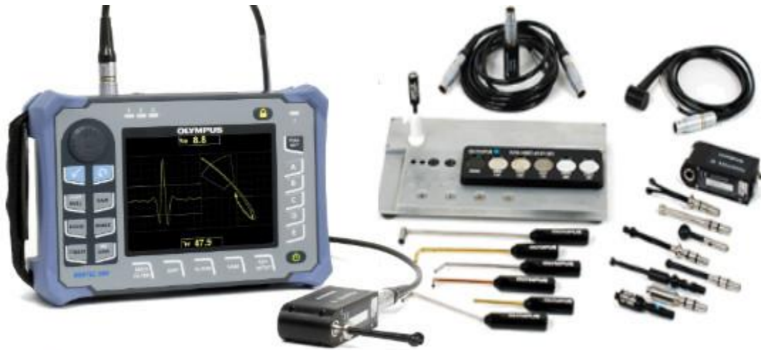
Figura 4. Instrumentos para inspección con corriente de Eddy.
