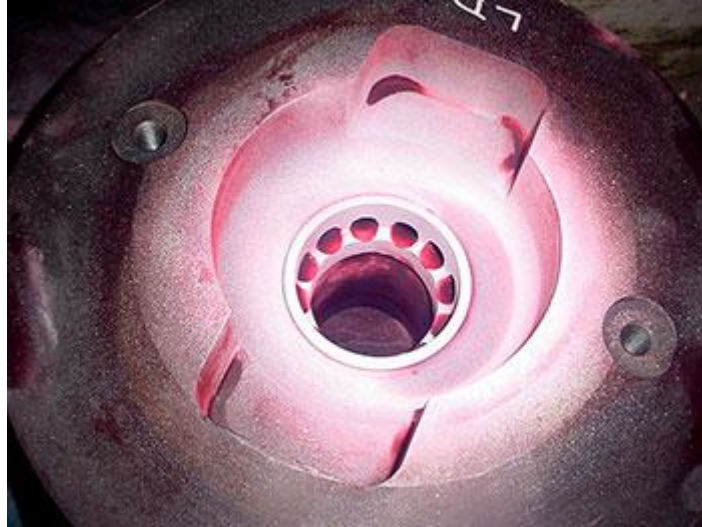
Figura 2. Ensayo no destructivos con líquidos penetrantes.
