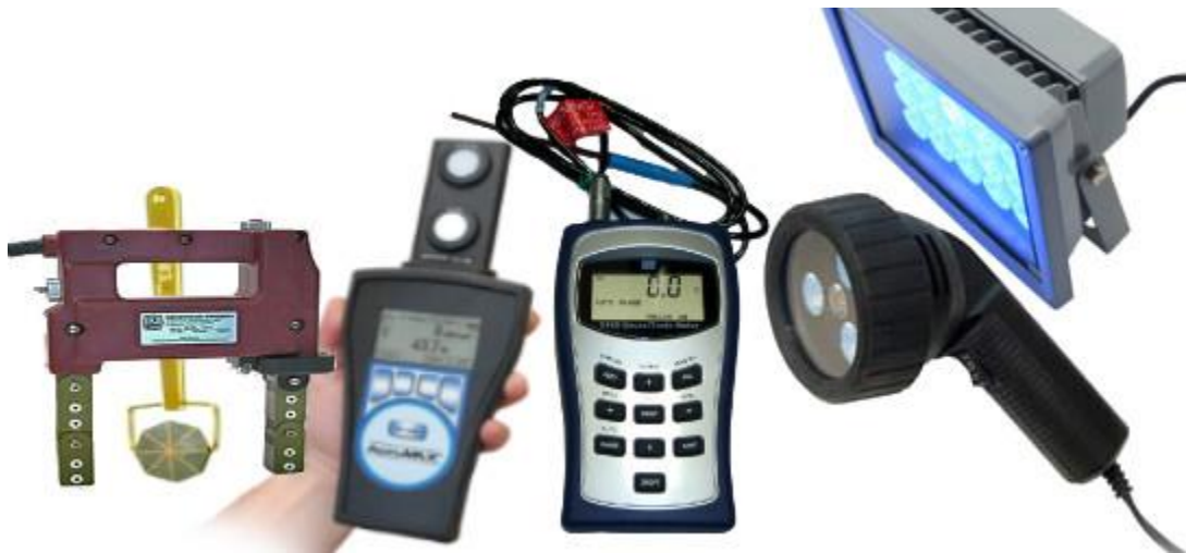
Figura 3. Instrumentos para inspección con partículas magnéticas.
