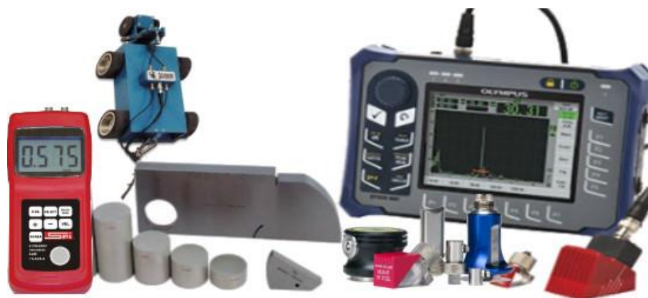
Figura 5. Herramientas utilizadas para la aplicación de pruebas con ultrasonido.
