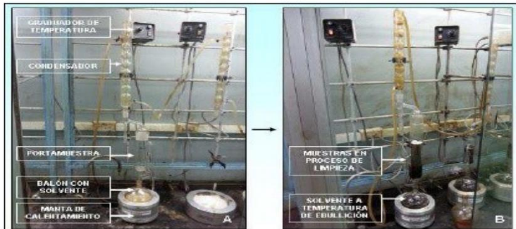
Figura 4.6. Equipo de limpieza de muestras Dean-Stark: A) antes de la limpieza de muestra y B) durante la limpieza de muestras.
