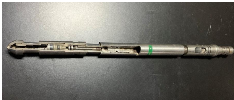
Figura 37. Válvula operadora por presión de inyección o Válvula calibrada. [Fuente: Tía Juana, Laboratorio de válvulas, 2018]
