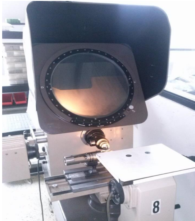
Figura 69. Proyector Prolife PH350 [Fuente: Empresa Metalúrgica EXCEL]
