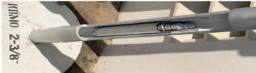
Figura 27. Mandril de bolsillo tipo KBMO 2-3/8". [Fuente: Tía Juana, Laboratorio de válvulas, 2018]
