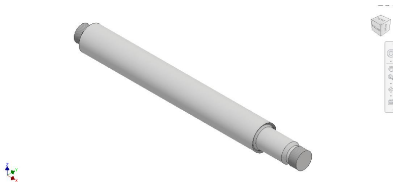
Figura 97. Boceto 3D del cuerpo macizo de la válvula orificio 1 ½ pulg. [Fuente: Autodesk Inventor Professional, 2018]
