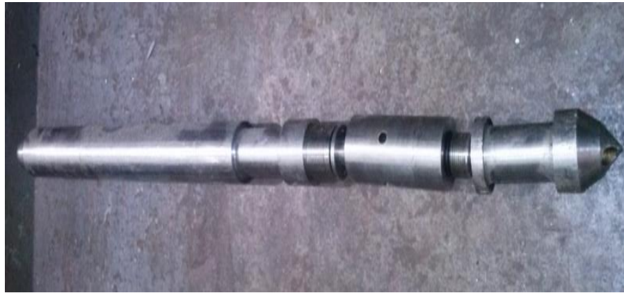
Figura 38. Válvula operadora por presión de inyección o Válvula calibrada. [Fuente: INTEVEP, Laboratorio de Levantamiento artificial, 2018]
