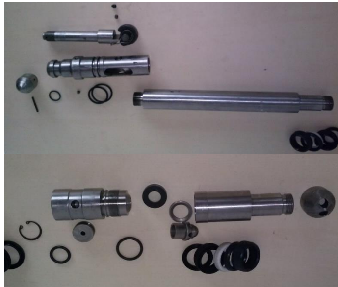
Figura 91. Despiece de la válvula orificio de 1 ½ pulg. [Fuente: Empresa Metalurgica EXCEL, 2019]
