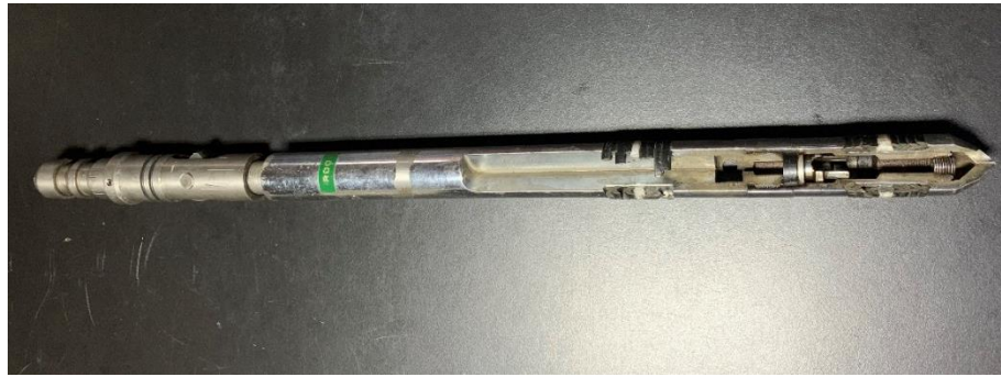
Figura 44. Válvula orificio [Fuente: Tía Juana, Laboratorio de válvulas, 2018]
