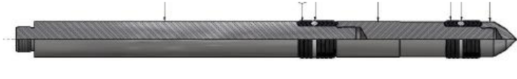
Figura 42. Válvula ciega. [Fuente: Barreto, 2017]
