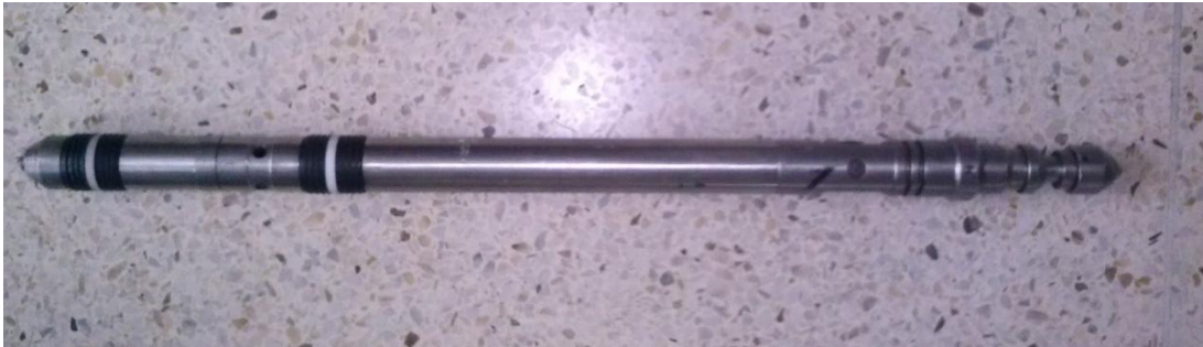
Figura 90. Válvula Orificio de 1 ½ de pulg aportada por la empresa mixta PDVSA Lagopetrol, en condición mecánica usada. [Fuente: PDVSA Lagopetrol S.A, 2018]
