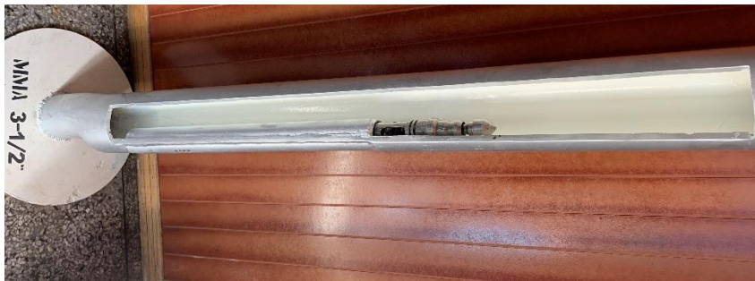
Figura 29. Mandril de bolsillo tipo MMA 3-1/2". [Fuente: Tía Juana, Laboratorio de válvulas]
