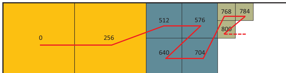
Figura 1.6: Estructura Strip con bloques ordenados por nivel de detalle. Bloques de mayor resolución se asumen de tamaño 32 \times 32 .
