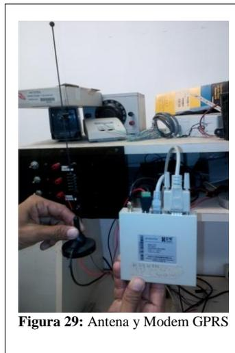
**Figura 29:** Antena y Modem GPRS
