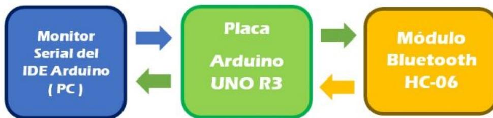
**Figura 26:** conexión para establecer los comandos AT
